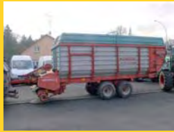
LAW 360 Super Bj. 1984 Quadro Zul. Gesamtgewicht 8000 kg, zul. Achslast 7200 kg, Stützlast 1000 kg, 2 Walzen, elektr. Bedienung, 16 Messer, 25 km/h
