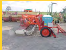
HRB 30D + 6000/S Kreiselegge Belrecolt mit Dirll-Lift., ZPW, Drillmaschine Isaria 25 Reihen, Schleppschare + Striegel
