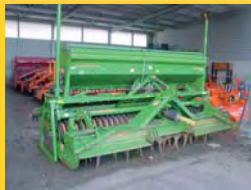
KG 403 + AD 403 Bj. 2002 Drillkombination 4 m, Kreiselgrubber KG 403 mit Rillenpackerwalze KW402/580 - SN. 3125, Drillmaschine AD 403 aufgesattelt mit Aufsatz, hydr. Spuranzeiger,
