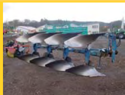
Star XD IV 70-35 Bj. 1988 4-Schar, Körper 320 W, Stroheinleger, Schare mit Spitzen, Scheibensech hinten
