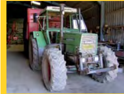
Favorit 614 LSA Bj. 1984 107 KW (145 PS) 8.530 h Hydraulik MHR, 2 DW Steuergerät, 1 hydr. AHB, Zapfwelle 540/1000 U/min, WKS Kat 3/2, Piton-Fix, 2 AS v.+h., mech. Zugmaul, FKH ohne FZW,
