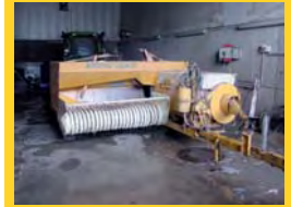
KR 50 Bj. 1981 mit Pick-up 1,80 m, zentr. Knoterschmierung, mit hydr. Ballenschleuder, mit Gelenkwelle,
